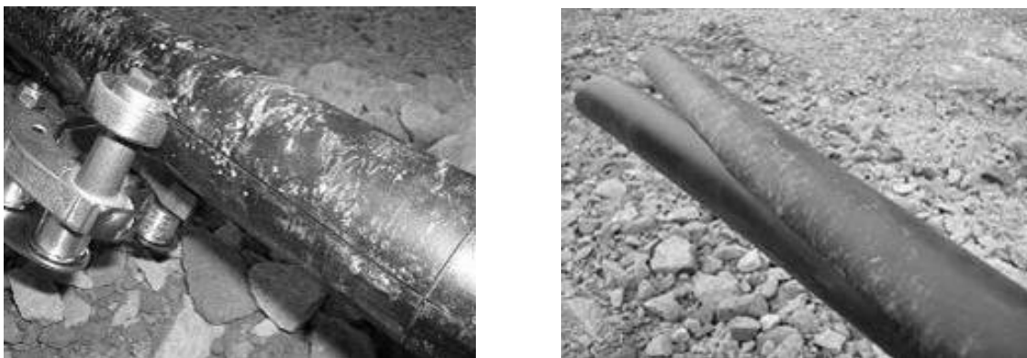
Slika 6 – Izgled SCC® plašta i standardnog plašta posle polaganja
