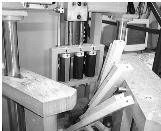
Slika 3 – Oprema za ispitivanje abrazijom
