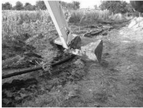
Slika 11 – Ispitivanje otpornosti kablova na terenu
